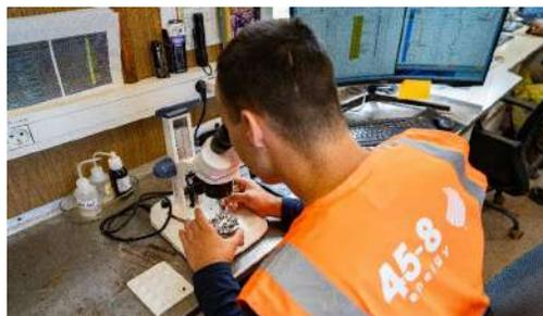
*Analyse compositionnelle d'échantillons récupérés lors de nos forages.*
